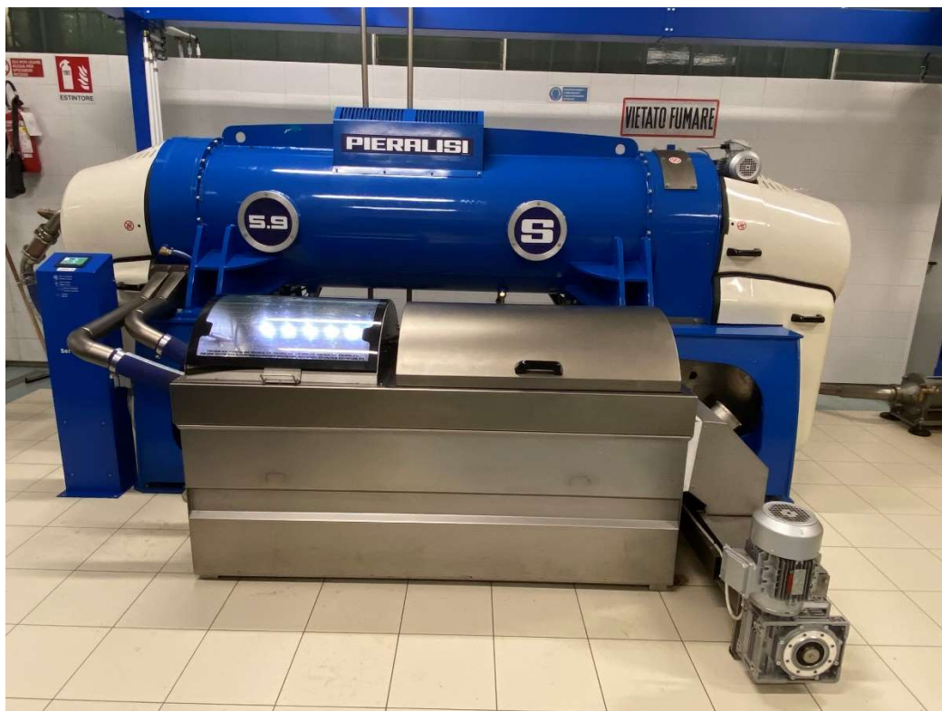
Figura 3 - Decanter mod. Scorpion 5.9 (Gruppo Pieralisi S.p.A., Jesi, Italia)
