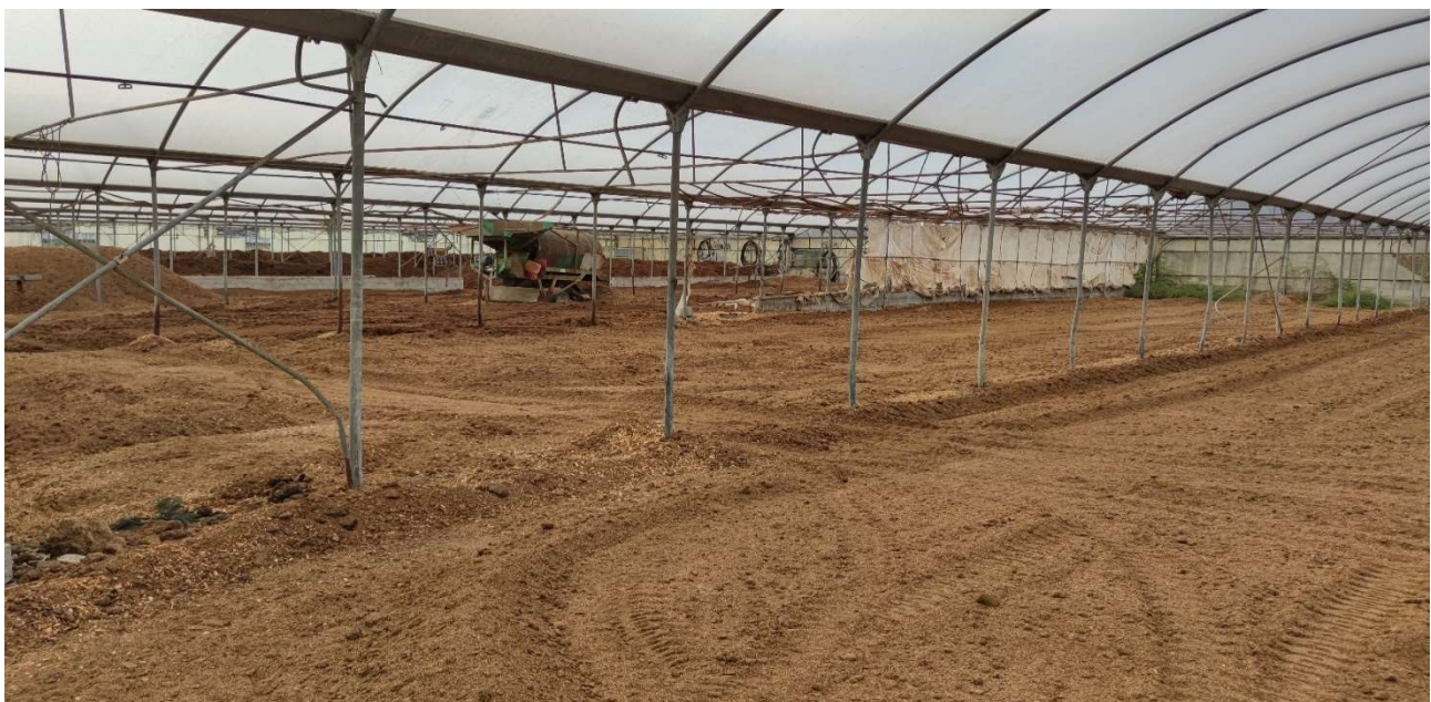
Figura 4 – Fase di essiccazione della sansa vergine d'oliva in serra a ventilazione naturale – Industria Pellets di Brescia Gavino partner del progetto
